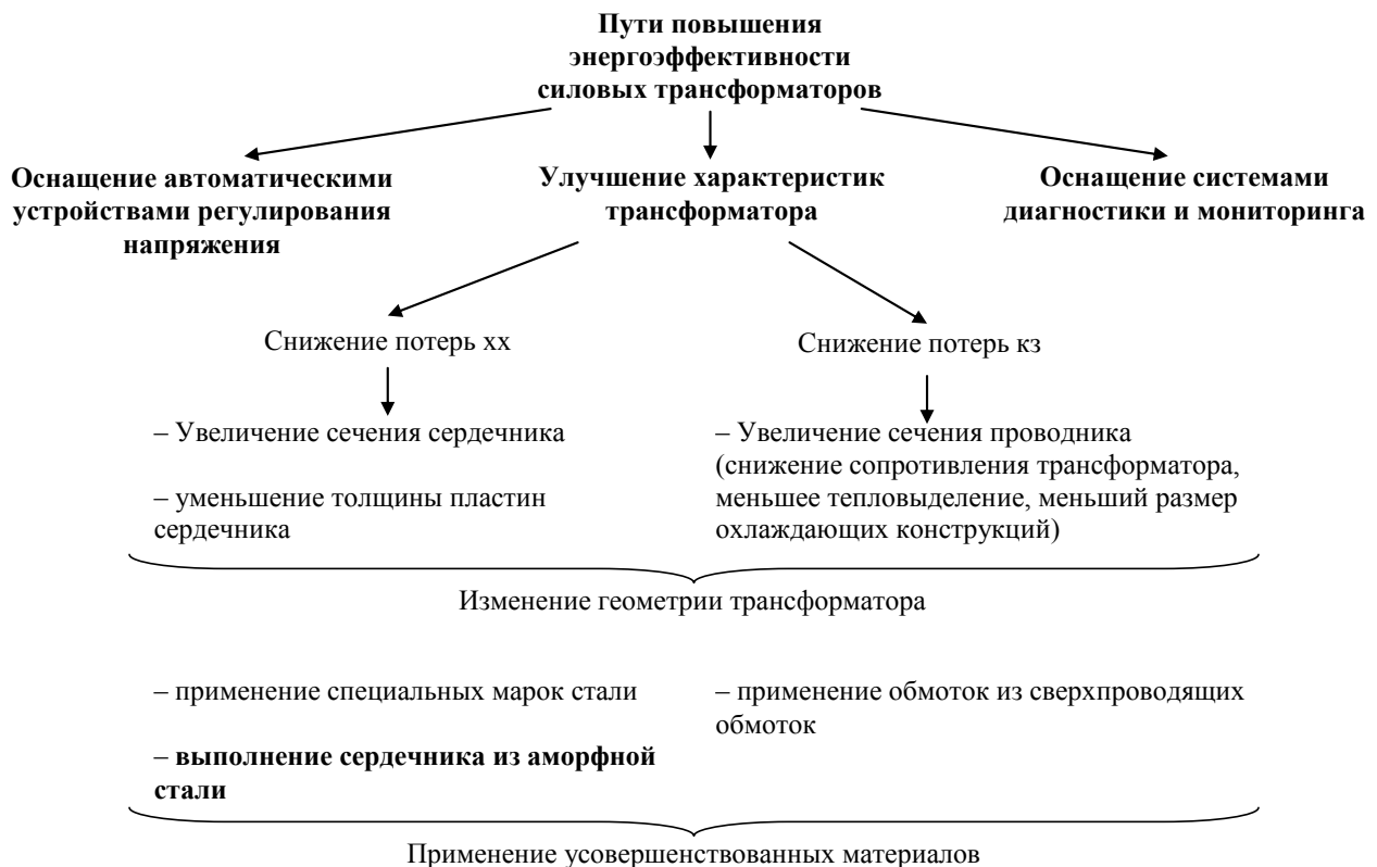
Рис. 5. Пути повышения энергоэффективности силовых трансформаторов
