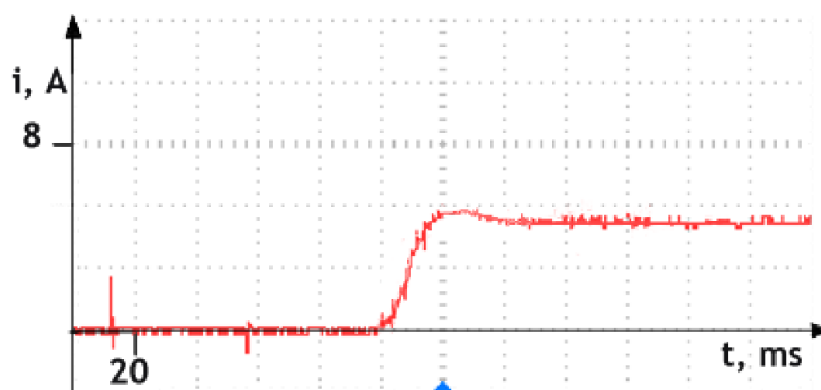
Рис. 5. Переходный процесс в контуре тока
