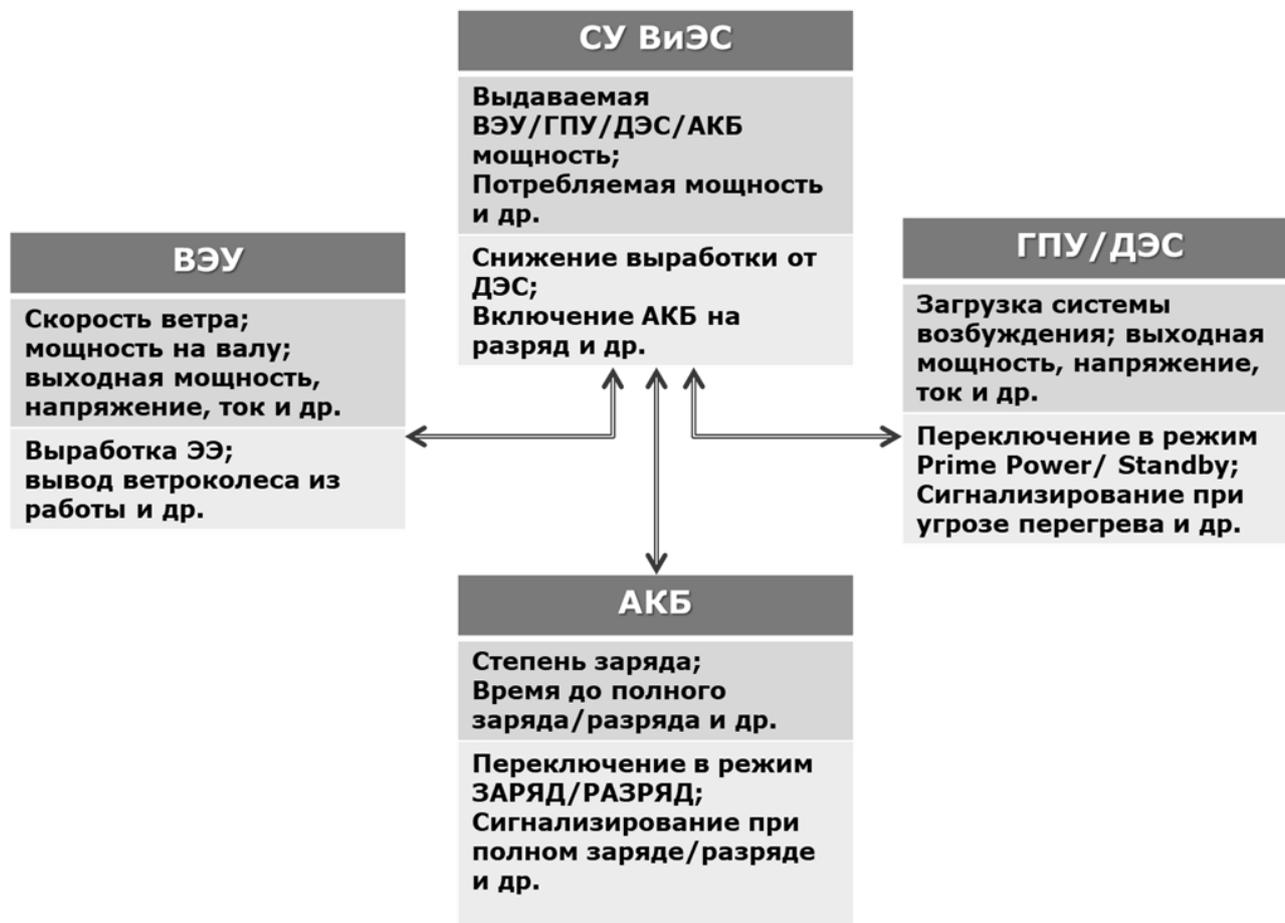
Рис. 3. Архитектура программной части имитационной системы
