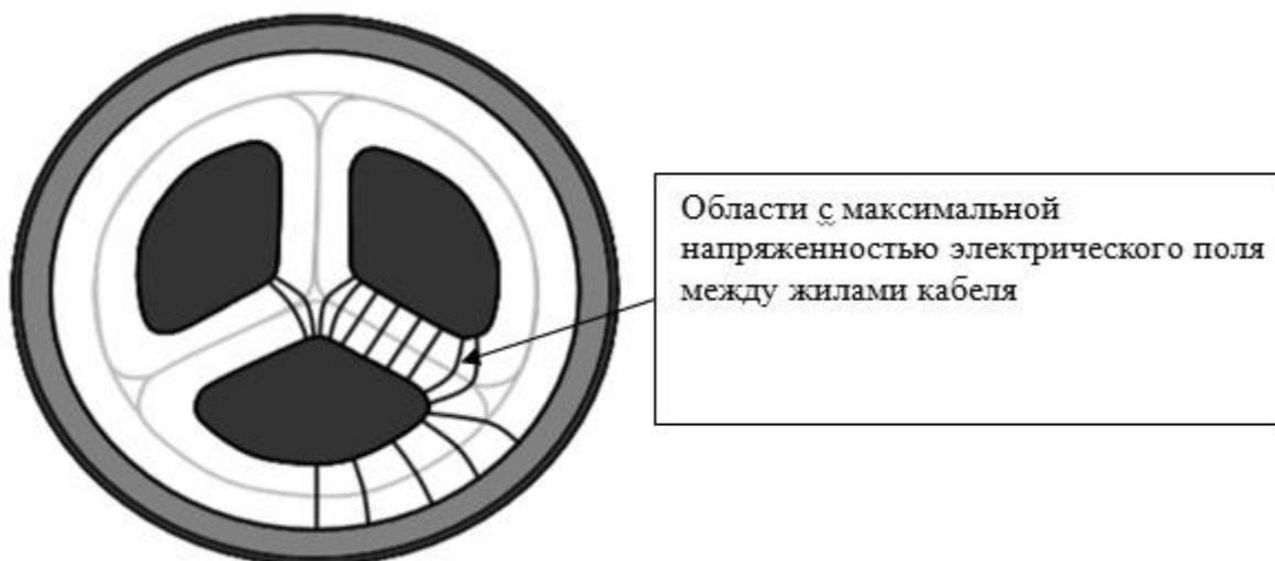
**Рис 4. Распределение линий напряженности электрического поля внутри трехфазного бронированного кабеля с бумажно-масляной пропитанной изоляцией**
