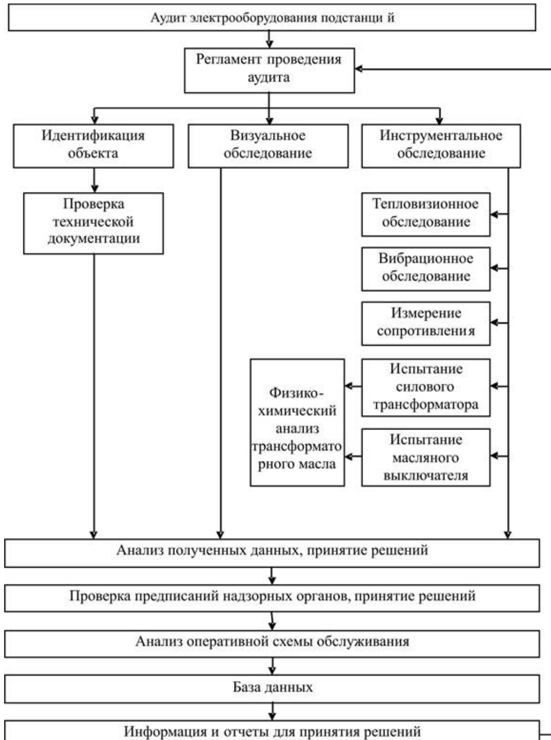
Рис.1. Структурная схема проведения аудита электрооборудования трансформаторной подстанции
