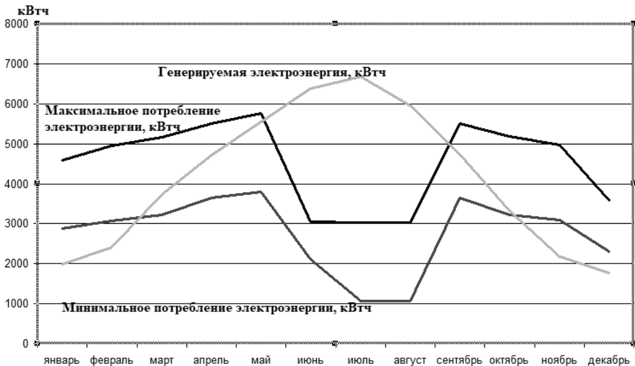
Рис. 2. Сравнение графиков генерации и потребления при использовании 93 солнечных панелей
