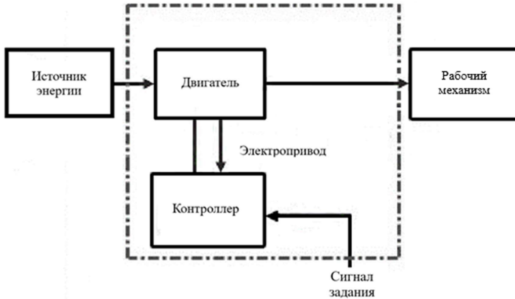
Рис. 1. Структурная схема электропривода
