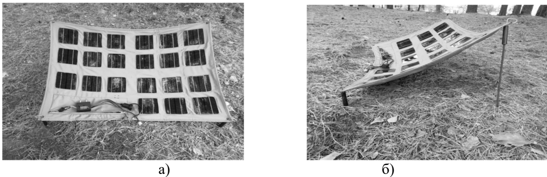
Рис. 4. Модуль фотоэлектрической системы, размещённый на земле на колышках: а - вид сверху; б – вид сбоку
