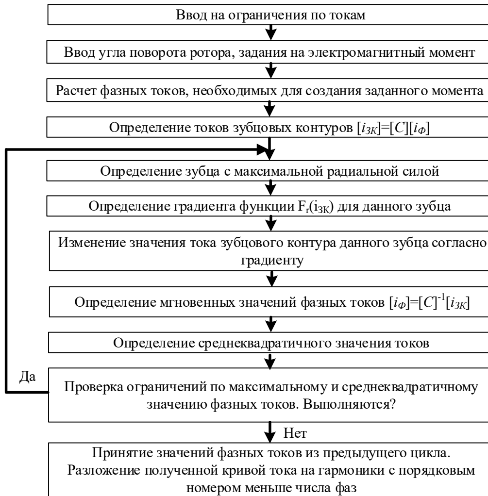
Рис. 1. Алгоритм формирования формы фазных токов, обеспечивающих улучшение виброшумовых характеристик многофазного СДПМ.
