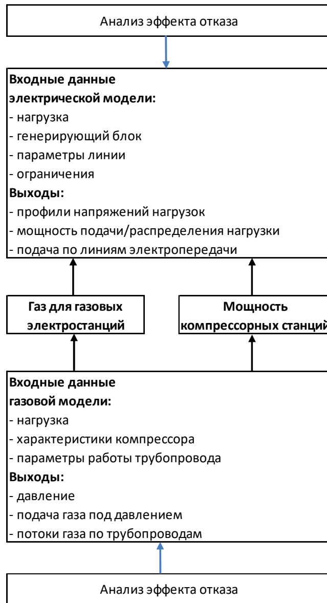
Рис. 1. Интегрированная модель электро-газоснабжения
