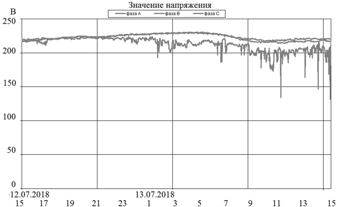
**Рис. 4. График изменения фазных напряжений за сутки**
