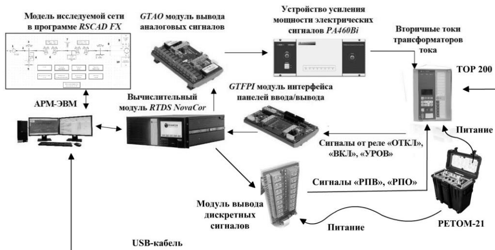
Рис. 8. Структура испытательной установки
