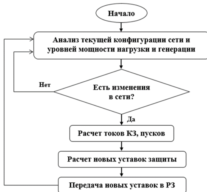
Рис. 2. Отдельные компоненты алгоритма разработанной адаптивной системы токовой защиты
