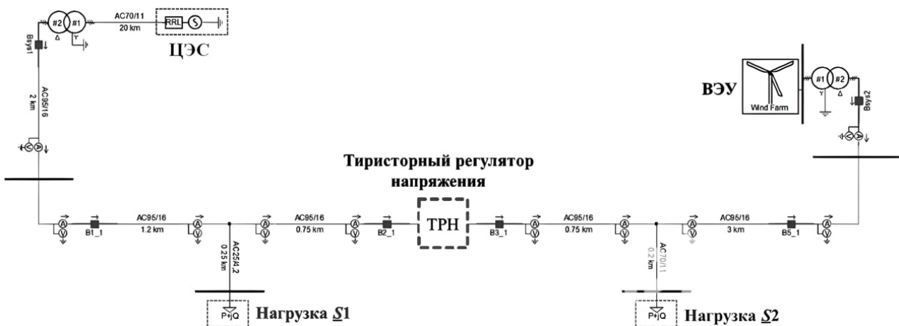
Рис. 2. PSCAD-модель участка РЭС с ВЭУ и ТРН: S_{1\text{НОМ}} = 3510 + j1620 кВ·А; S_{2\text{НОМ}} = 3993 + j1722 кВ·А
