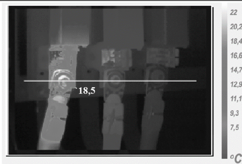
Рис. 2. Термограмма КС секции шин РУ (2024 г.)
