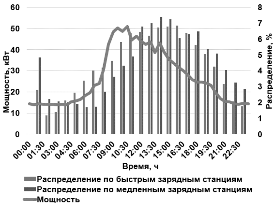
Рис. 3. Совмещение графика распределения зарядных сессий по времени суток и графика электрической нагрузки городской поликлиники
