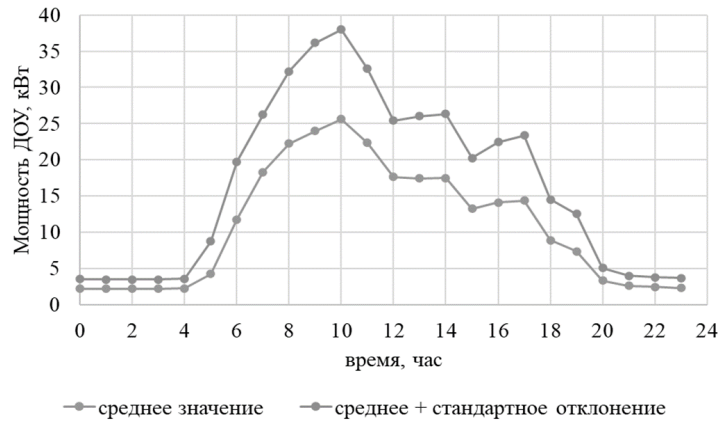
Рис. 3. График усредненной нагрузки дошкольных образовательных учреждений г. Москвы
