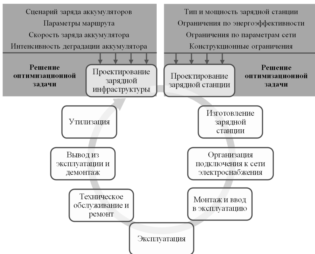
Рис. 1. Модель жизненного цикла системы беспроводного заряда
